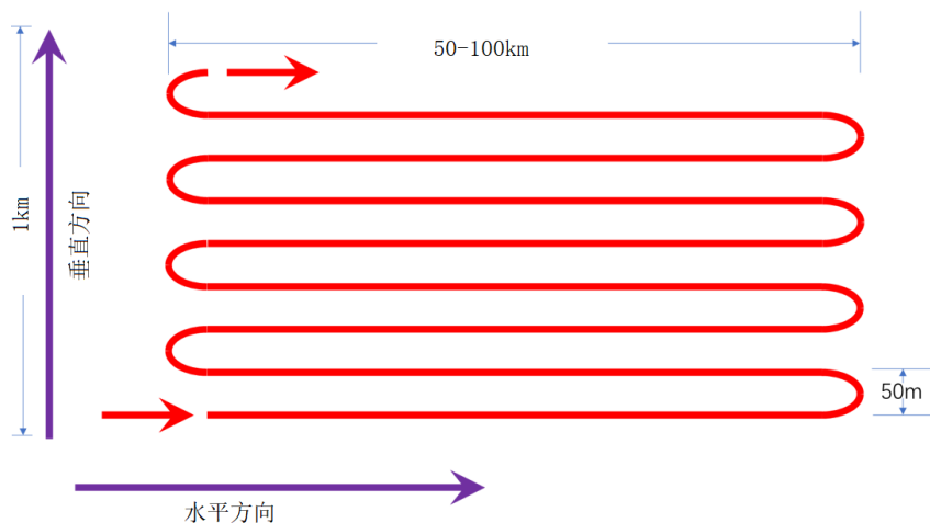
图 A. 2 幕式飞行探测示意图
